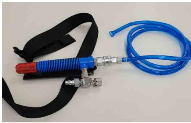
冷気変換装置の例
