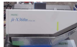
図-3 残留応力測定装置
