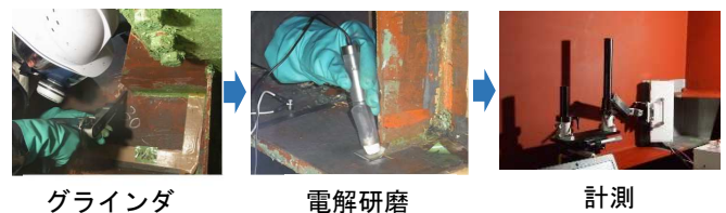
図-4 残留応力測定手順
